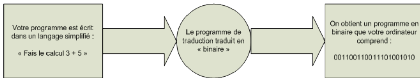
FIGURE 1.1 – Traduction d'un programme en langage binaire
